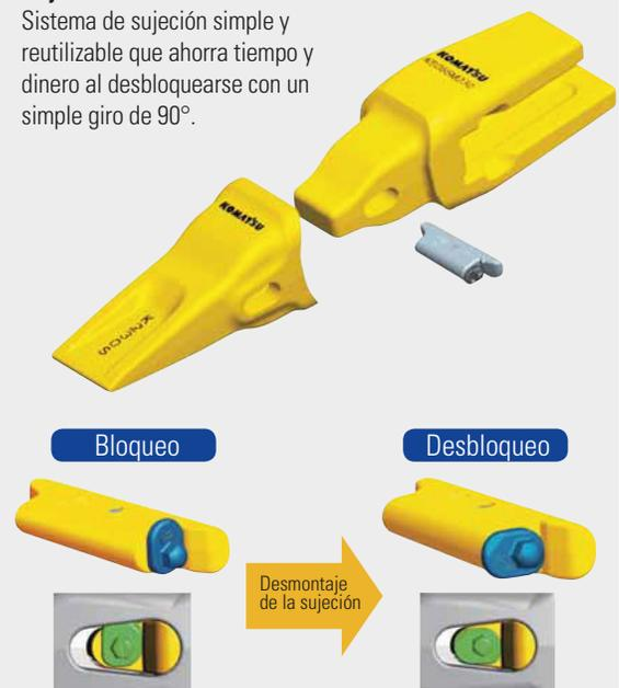
Al desmontar la sujeción, use un dado del tamaño correcto para rotar el eje de bloqueo del pasador en 90° hacia la izquierda.
